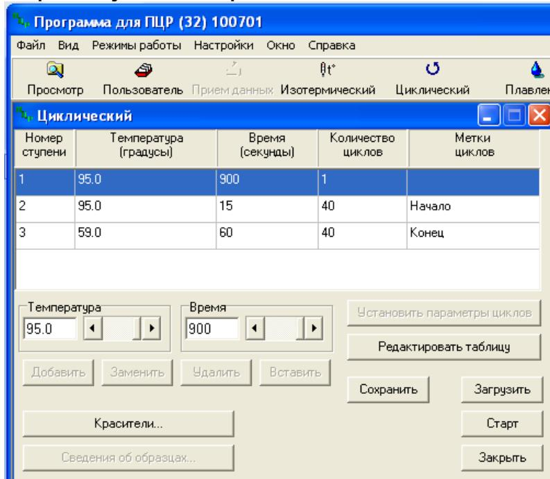
3. Температура и время каждого шага/ступени амплификации устанавливаются в нижней половине окна, с помощью клавиатуры или бегунков. После установки каждого значения необходимо нажать кнопку **Заменить**. Для изменения количества шагов используются кнопки **Добавить**, **Удалить** и **Вставить**.
